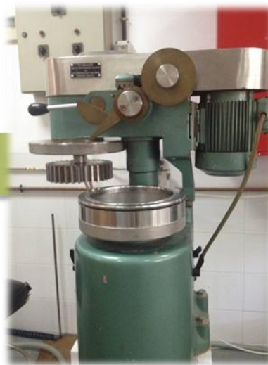
Molino PFI Desfibrilación sin cortar fibras
